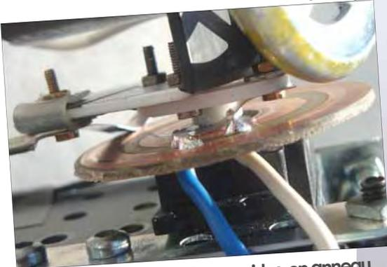
▲ Collecteur tournant avec pistes en anneau et languettes de contact permettant la rotation.
