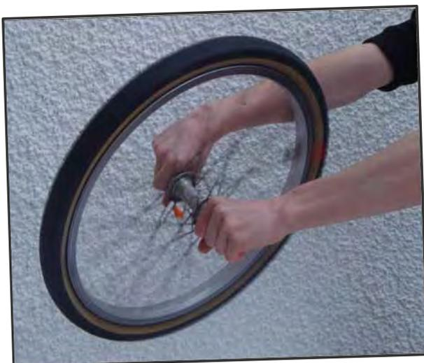
La roue est tenue verticalement par les deux extrémités de son axe par une personne qui tente d'appliquer un changement de direction à cet axe : l'effet constaté est surprenant car la roue résiste au changement de rotation et réagit en s'orientant horizontalement.
