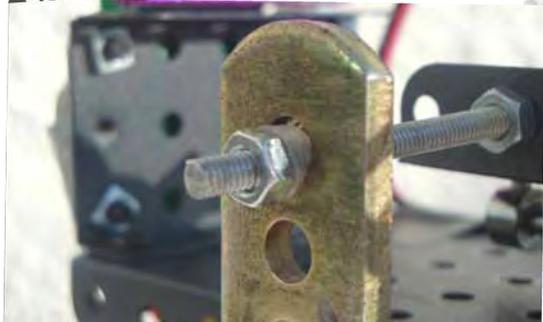
▲ Liaison pivot réalisée avec des rondelles en plastique.
