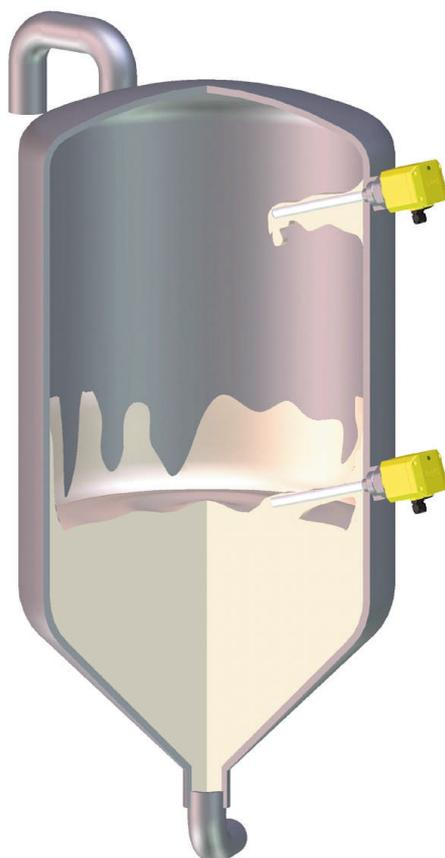
*Le colmatage sur l'électrode n'a aucune influence sur la détection*
