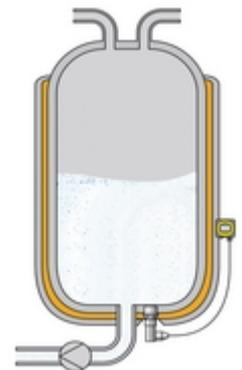
Mesure de niveau par capteur de pression hydrostatique monté en pied de tank.
