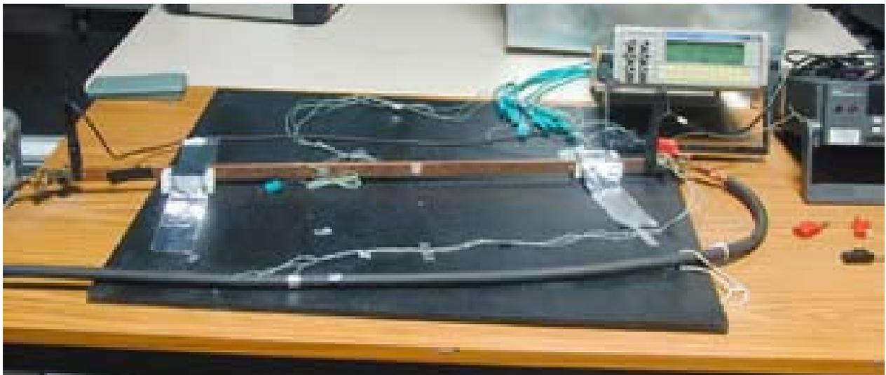
Figure 15 : mesure de la température d'une barre en cuivre par capteur de température de surface
