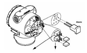
POSITIONS DU CAVALIER DE TENSION DE SORTIE POSITIONS DU CAVALIER DE SECURITE DU TRANSMETTEUR
