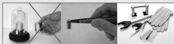
Figure 38. Manipulation d'un poids.
